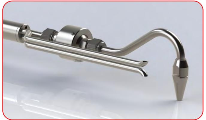
Questa soluzione costruttiva rende la CP2 uno strumento versatile sia per misure di velocità che per prelievi di specie inquinanti in ambiti dove le normali sonde isocinetiche non sono utilizzabili per via delle loro dimensioni.
